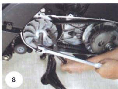
8. ถอดน็อตเบอร์ 14 ที่พูลเลย์จับ โดยใช้เครื่องมือพิเศษตัวจับ 07725 - 0030000
