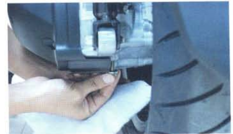
ถอดโบลท์ตรวจระดับน้ำมันเฟืองท้าย
