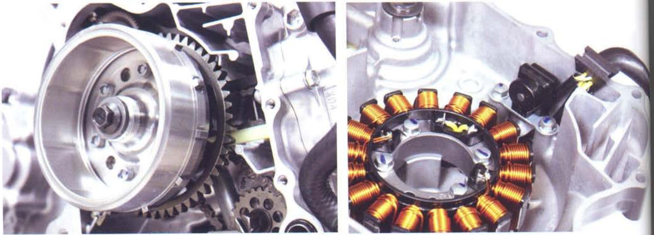
ภาพแสดง ตัวตรวจจับตำแหน่งเพลาคือเหวี่ยง : CKP Sensor
