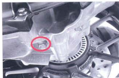
โบลท์ถายน้ำมันเฟืองท้าย อยู่ด้านล่าง
