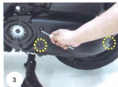
3. ถอดโบลท์หกเหลี่ยม 3 ตัวที่ฝาครอบห้องสายพานตัวบนนอก
