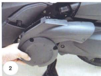
2. ถอดฝาครอบกรองอากาศห้องสายพาน
