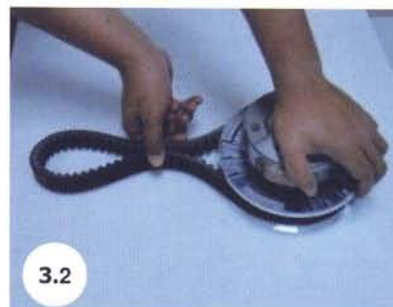
3. ใช้มือบีบพูลเลย์ให้ร่องของพูลเลย์ขยายออกแล้วประกอบสายพานเข้ากับพูลเลย์ โดยพยายามให้สายพานเข้าไปอยู่ในพูลเลย์ให้ลึกที่สุดเท่าที่จะทำได้
