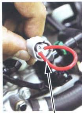
หัวสายไฟตัวตรวจจับ อุณหภูมิน้ำหล่อเย็น
