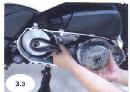
3. ใช้มือบีบพูลเลย์ให้ร่องของพูลเลย์ขยายออกแล้วประกอบสายพานเข้ากับพูลเลย์ โดยพยายามให้สายพานเข้าไปอยู่ในพูลเลย์ให้ลึกที่สุดเท่าที่จะทำได้
