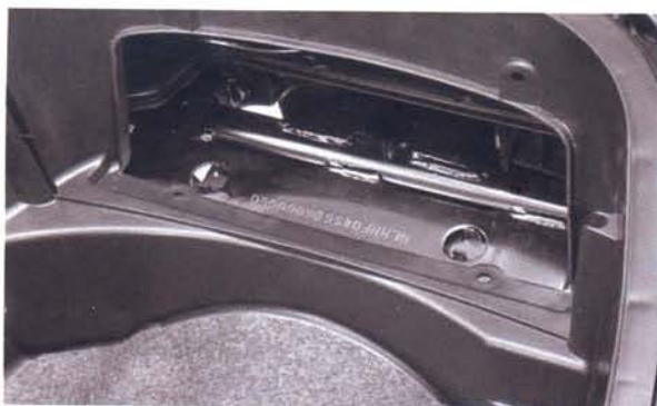
หมายเลขตัวถังของรถรุ่น FORZA300 อยู่ด้านท้ายของตัวถังใต้เบาะนั่ง
