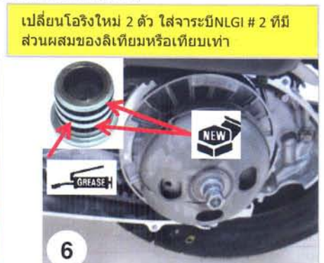
6. ประกอบฝาครอบเข้ากับพูลเลย์ตามและใส่แหวนรองและโบลท์เบอร์ 17
