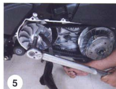
5. ขันน็อตยึดพูลเลย์ขับเคลื่อน น็อตเบอร์ 14 อัตราการขันแน่น 83 นิวตันเมตร
