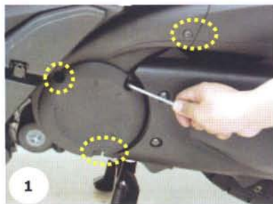
1. ถอดโบลท์หกเหลี่ยม 3 ตัวที่ยึดฝาครอบกรองอากาศห้องสายพาน และสกรู 1 ตัว
