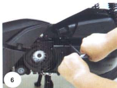
6. ถอดโบลท์เบอร์ 8 11 ตัวที่ฝาครอบสายพานนอก
