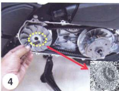
4. ประกอบพูลเลย์ขับเคลื่อนให้เข้าร่องสปายและใส่โบลท์เบอร์ 14 กับแหวนรอง
