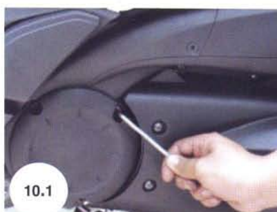
10. ประกอบฝาครอบกรองอากาศห้องสายพาน
