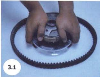
3. ใช้มือบีบพูลเลย์ให้ร่องของพูลเลย์ขยายออกแล้วประกอบสายพานเข้ากับพูลเลย์ โดยพยายามให้สายพานเข้าไปอยู่ในพูลเลย์ให้ลึกที่สุดเท่าที่จะทำได้
